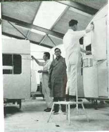
„En dat is de KIP-schoonheidssalon. Hier worden de caravans geplamuurd alvorens te worden gespoten”.
