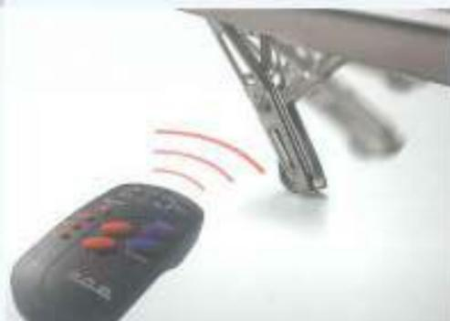
**Nieuw** Op afstand te bedienen elektrische uitdraaisteunen van Alko. Niet meer door de knieën, geen gedoe met de draaislinger, maar een simpele druk op één van de vier toetsen en de gekozen steun beweegt zich volautomatisch richting vaste bodem. Het horizontaal zetten van de caravan kunt u zo tot in de finesses bepalen. Het inklappen van de steun gaat op dezelfde eenvoudige wijze.
